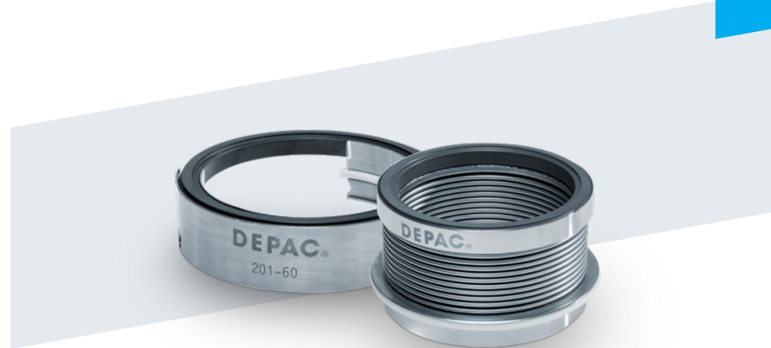
Die Type 201 ist eine stationäre, druckentlastete Gleitringdichtung. Die GLRD ist für anspruchsvolle Einsatzgebiete konzipiert – darunter Heißwasser- und Chemie-Anwendungen. Die Type 201 dichtet zuverlässig bei Temperaturen bis zu 240 Grad Celcius und 20 bar Druck. DEPAC empfiehlt, bei Druck-Belastungen über 10 bar die Wellen bzw. Hülsen für die Setzschraubenbefestigung anzubohren.
