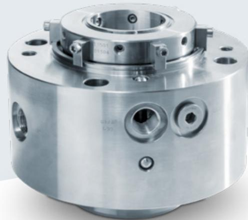
Die Type 385 ist eine stationäre, tandem-wirksame Doppel-Gleitringdichtung. Speziell für die Anforderungen der Petroleumindustrie konzipiert, ist die Type 385 mit einem Sperrraum mit einer patentrechtlich geschützten Pumpkonstruktion und Sperrflüssigkeitsumlenkung ausgerüstet.
