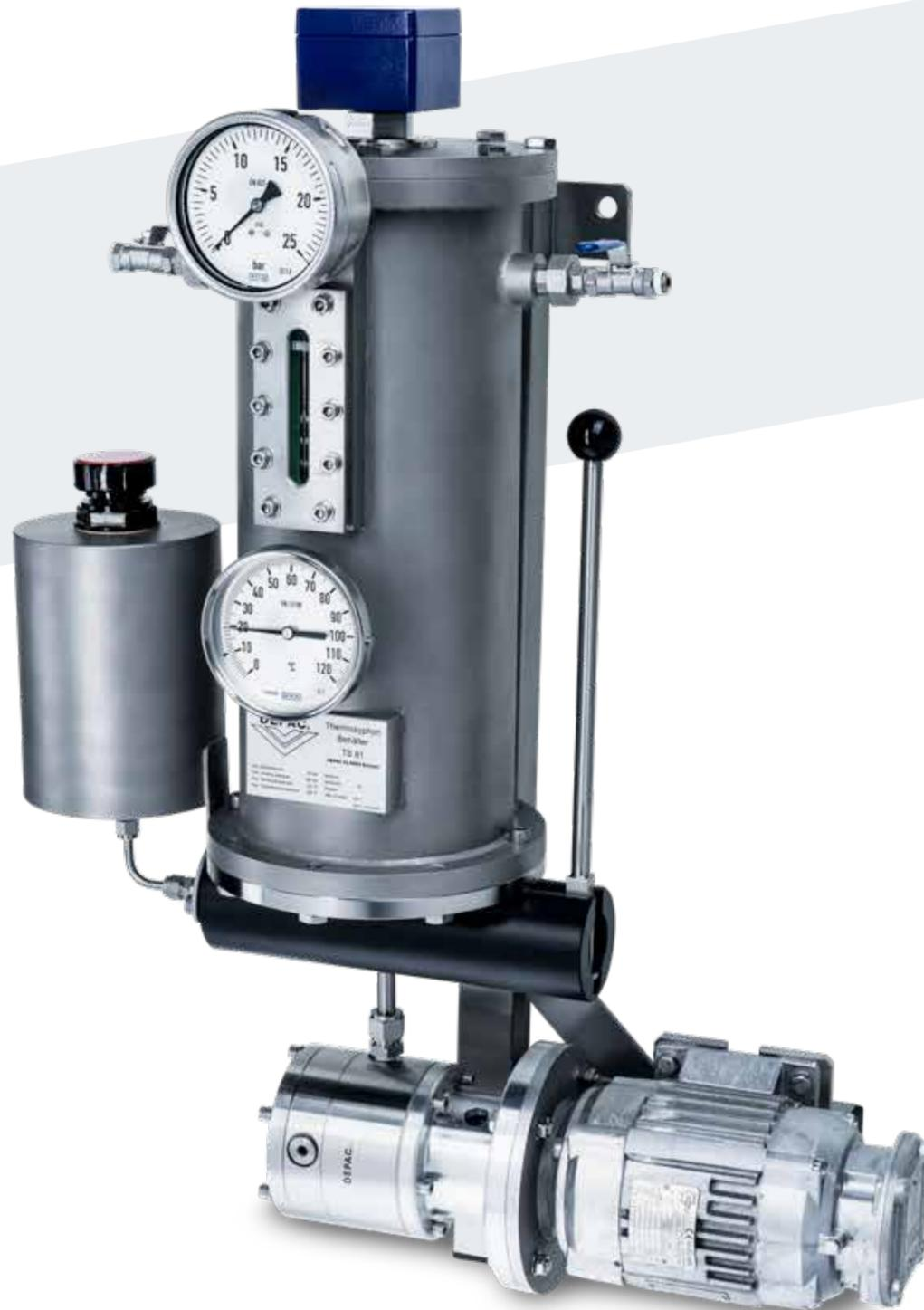
Das DEPAC Thermosiphonsystem TS80 | TS81 ist ein einfach aufgebautes und zuverlässig arbeitendes Versorgungssystem für doppelwirkende Gleitringdichtungen. Es kann sowohl für DEPAC Dichtungen, als auch für Doppeldichtungen aller anderen Hersteller verwendet werden. Das System ist standardmäßig mit einem Schauglas zur Füllstandsüberprüfung und allen Systemanschlüssen ausgestattet. Weitere Systemkomponenten sind optional erhältlich.
